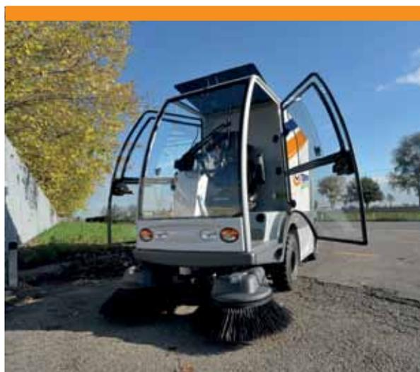
100% visibilità, con portiere a vetratura totale, oblò a pavimento per il controllo della bocca, telecamera posteriore sulla zona di spazzamento.
