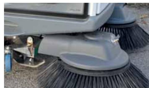
*Zero polveri: il sistema di abbattimento polveri alimentato da un serbatoio d'acqua da 400 litri include ugelli nebulizzatori sulle spazzole e sul condotto di aspirazione.*
