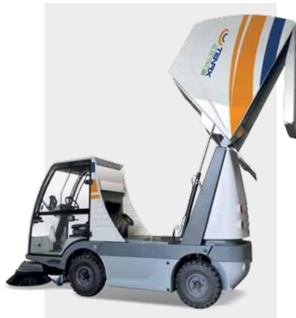
*Capace e funzionale: contenitore rifiuti da 1,5 m<sup>3</sup> e contenitore ribaltabile in quota di serie per ridurre al massimo i tempi di scarico.*
